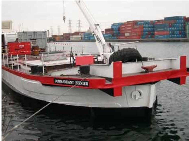
Sur ce bateau, la société C.M. Mouquet a effectué des travaux de maintenance classique (carénage, entretien général). Elle a de plus procédé à la réhabilitation totale du fond de coque par la mise en place d'un double fond sur une longueur de 34 mètres, à la transformation des réseaux de traitement des eaux ainsi qu'à la mise en place de la climatisation et la révision du réseau électrique.
